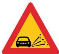
(K-13) Επικίνδυνη εκτίναξη χαλίκων (ασύνδετο αμμοχάλικο).
